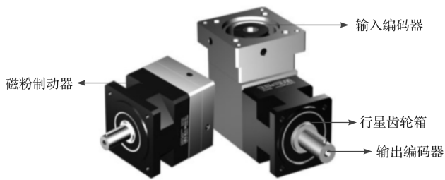
图 3 仿真实验平台原理图
