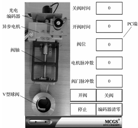
图 5 实验装置及监控系统
