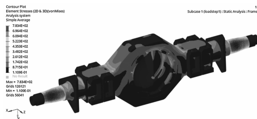
图 12 改进叉车过载过颠簸块工况桥壳应力
