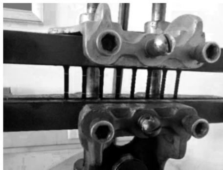
图 2 橡胶拉伸疲劳试验工装
