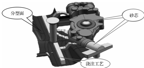
图2 铸件分型工艺
