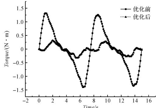
图 5 齿槽转矩对比
