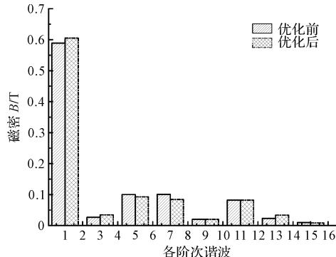
图 6 开槽前后径向气隙磁密 FFT 对比
