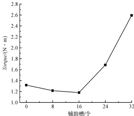
图 2 辅助槽个数与齿槽转矩的关系
