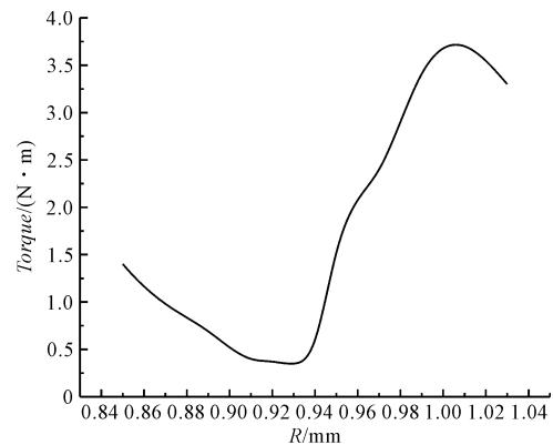
图 4 辅助槽深度与齿槽转矩关系
