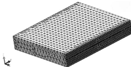
图 3 MEMS 加速度开关的有限元模型
