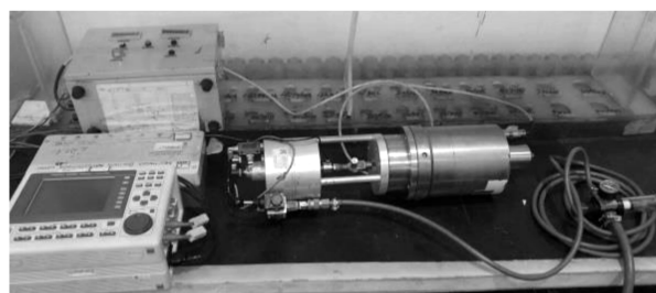
(b) 电磁力测量系统实物图
