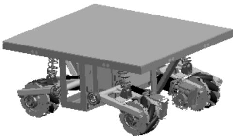
图 1 全向移动平台三维模型
