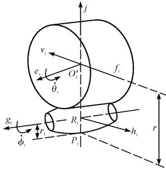
图 3 第  $i$  个 Mecanum 轮结构原理图
