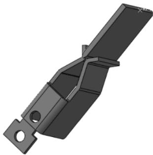
图 8 实际工作状态下引脚与插拔结构的位置关系
