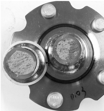
图6 试验后断裂法兰盘
