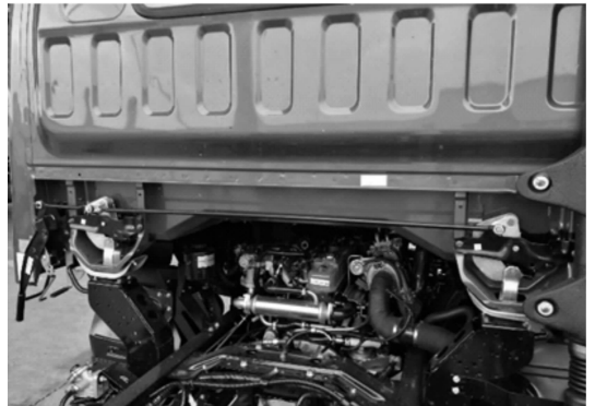
图3 锁止机构总成的安装图片
