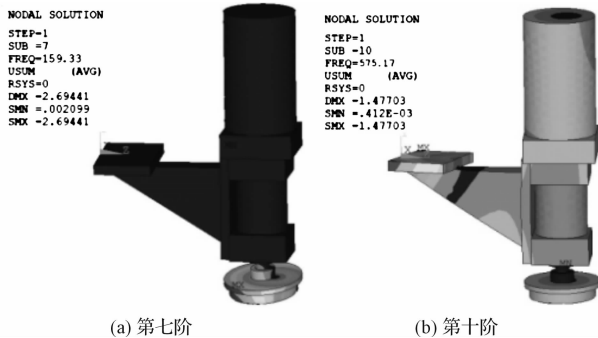
图2 80 mm保持架气压砂轮抛光工具自由状态下振型图
