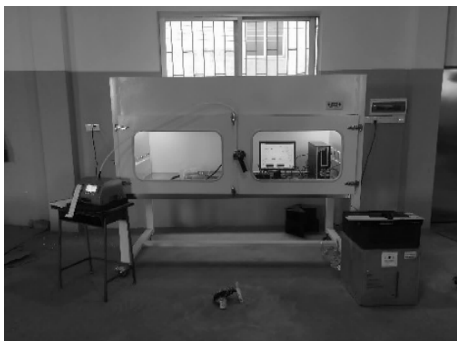
图 1 发尘量检测实验台
