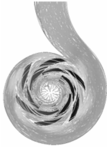
图3 设计流量 100 \text{ m}^3 \cdot \text{h}^{-1} 时离心泵内部流线图
