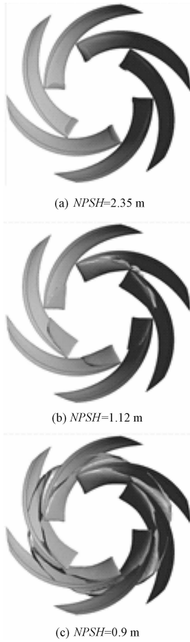
图 5 不同汽蚀余量时叶轮空泡分布
