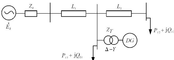
图 7 光伏接入电网接线图
