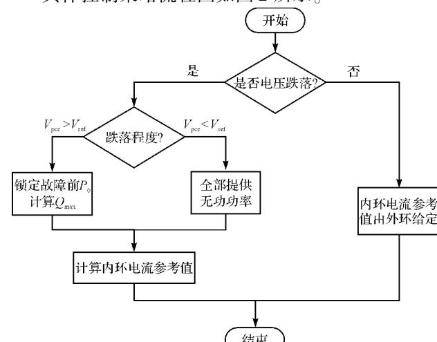
图 2 控制策略流程图
