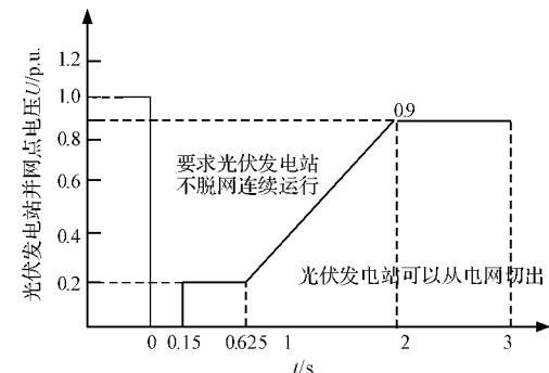
图 1 光伏发电站低电压穿越要求
