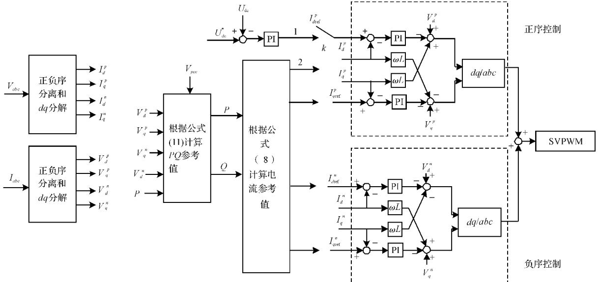
图 4 不对称故障时低电压穿越控制框图
