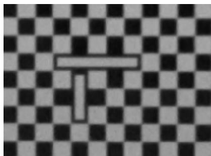
图 4 丝印机标定靶特征点
