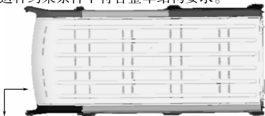
图 3 截取的车顶结构有限元模型
