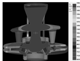
图 9 叶轮凝固过程剖视图
