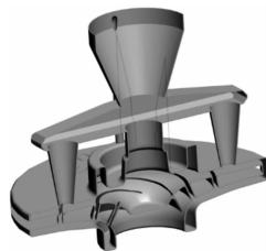
图 4 抽壳后叶轮整体模型剖视图
