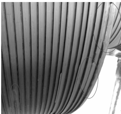
图 1 断裂的汽封片和汽封片脱落后的凹槽
