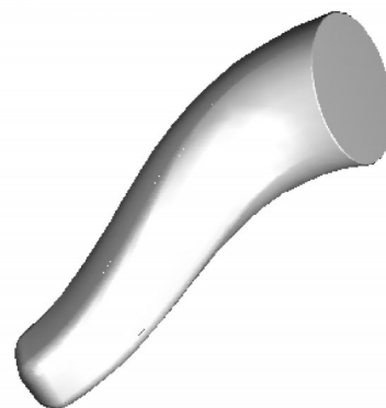
图2 某型号飞机的S形进气道
