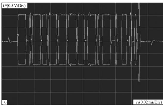
图4 a点测量动力CAN高线断路波形
