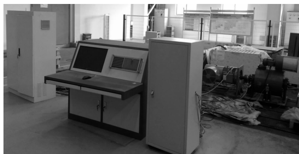
图 2 风电机组变桨加载试验台的实物图
