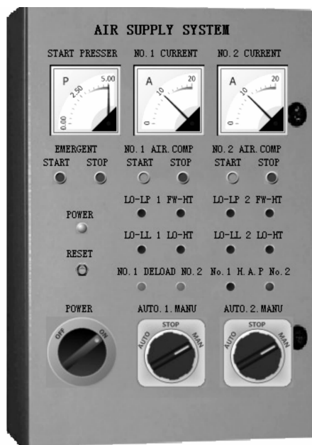
图 6 空气压缩虚拟操作系统电气控制箱的运行状态图
