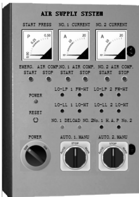
图 4 空气压缩虚拟操作系统的电气控制箱
