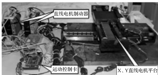
图 9 直线电机驱动的运动控制平台
