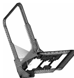
图 8 座椅质心水平向前向后施力
