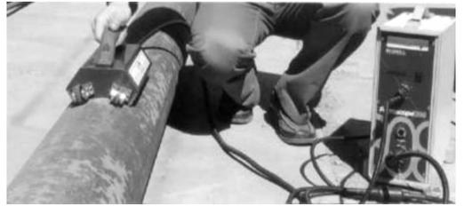
图4 平面式组合探头检测仪
