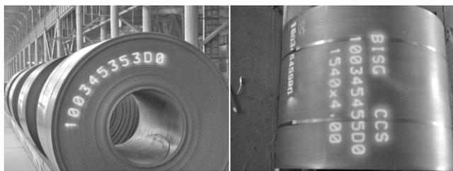
图6 机器人卷板喷标系统应用效果
