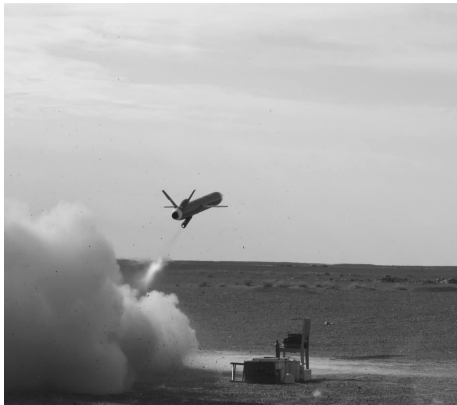
图5 发动机挂载无人机空中点火飞行试验图
