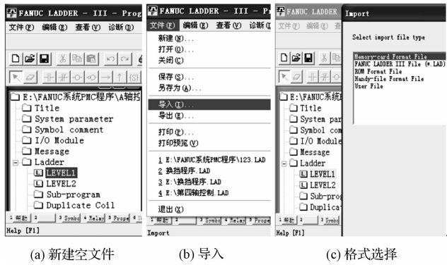
图 5 M-CARD 格式的 PMC 转换梯形图格式的 PMC 梯形图。
