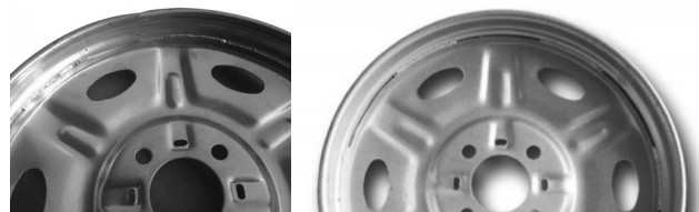
(a) 手动焊接焊缝
