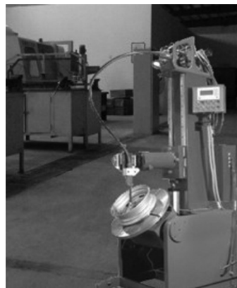
图5 试验焊机照片
