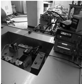
图4 2D数字伺服阀测试系统
