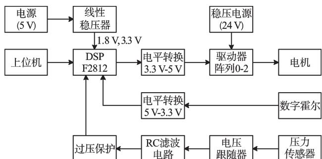
图2 假手控制系统结构
