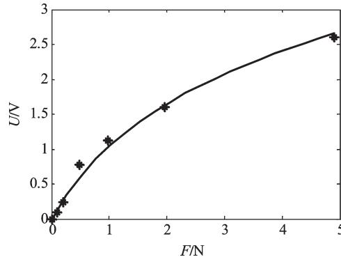
图5 FSR输出电压随压力的变化曲线
