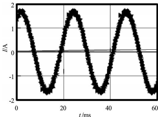
(a) 通过电流重构后的A相相电流波形
