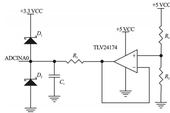
图4 FSR信号调理电路
