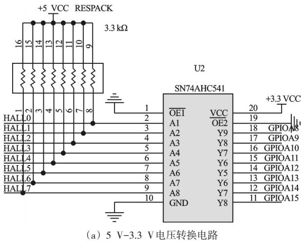
(a) 5 V-3.3 V电压转换电路
