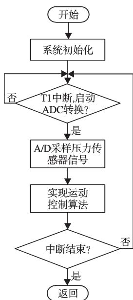
图6 控制软件流程图
