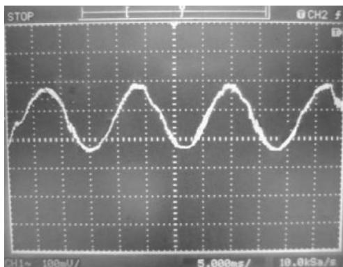
(b) 实测的A相相电流波形
