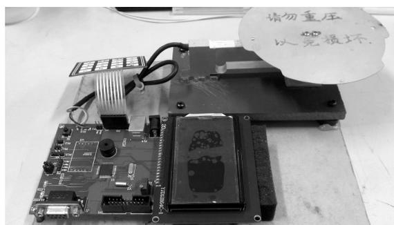
图7 电子天平实物图
