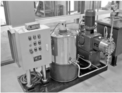
图4 固液两相流精密光整加工实验平台实物图
