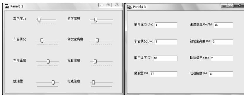
图 5 传感器输入与显示面板
