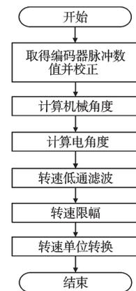
图12 转速测量流程图
