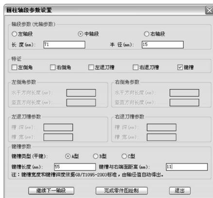
图 4 圆柱轴段的参数设置窗口
