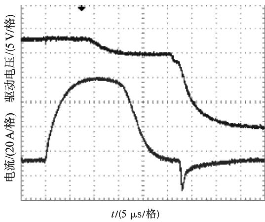
图9 短路保护测试结果
