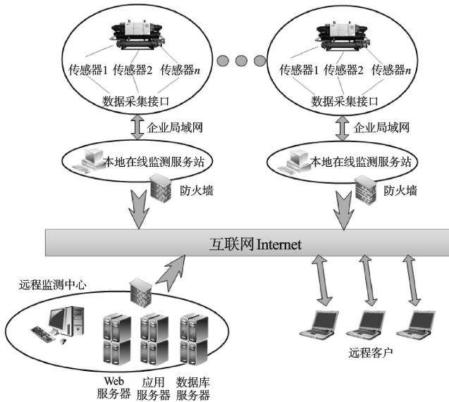
图1 压缩机远程监测系统网络结构
