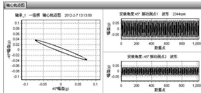
图7 某压缩机阳转子轴心轨迹图
