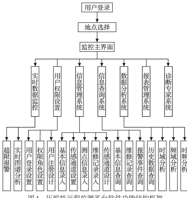
图4 压缩机远程监测平台软件功能结构框架
