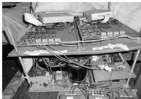
图 2 无刷双馈风力发电系统变流器实物图
