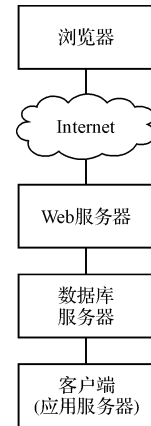
图 3 B/S 和 C/S 混合 Web 结构
