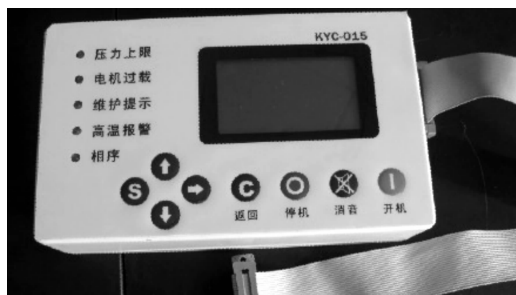
图 7 空压机控制器实物
