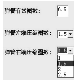
图 6 圆柱螺旋压缩弹簧有效圈和支承圈圈数的选择
