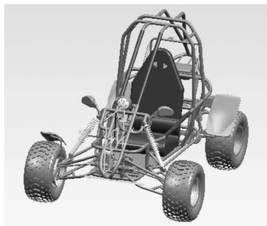
图 8 某型卡丁车三维数模
