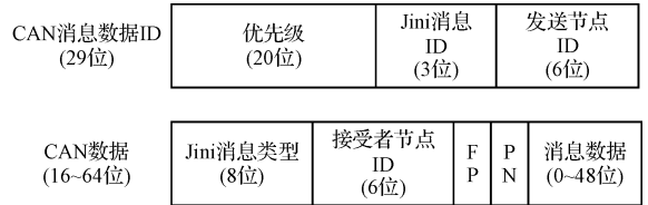
图 3 CAN 总线中的 Jini 消息 ID 模式
