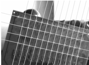
图6 有一定背景干扰下对灯板位置的高精度适应
