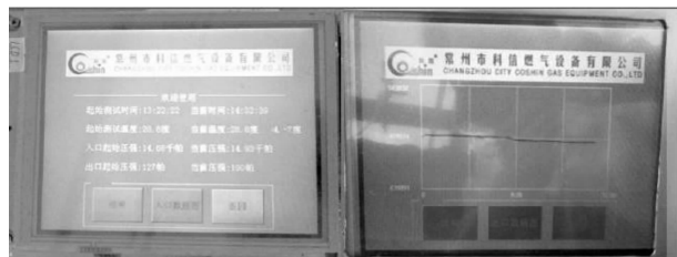
图 6 燃气调压器检测系统控制界面
