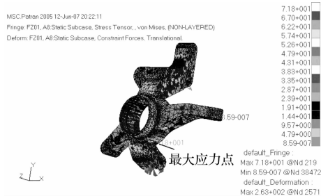
图 2 穿过不平路面应力分布云图(单位:MPa)
