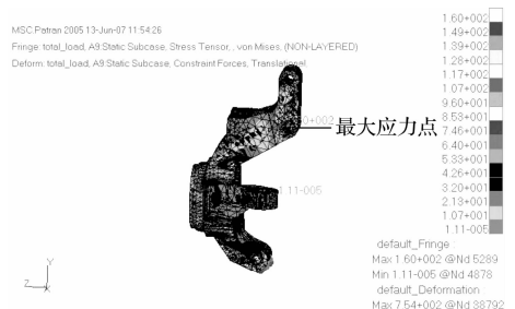
图 8 3 种危险工况同时发生工况应力分布云图(单位:MPa)
