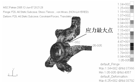
图 7 转向不侧滑和穿过不平路面同时发生工况应力分布云图(单位:MPa)
