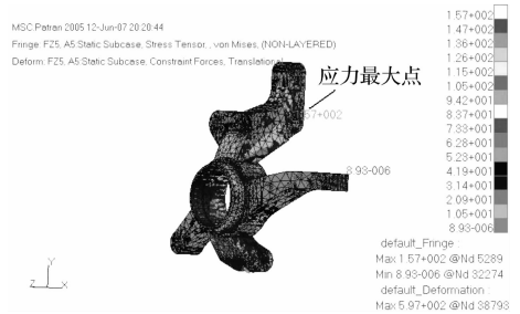
图 6 紧急制动和转向不侧滑同时发生工况应力分布云图(单位:MPa)
