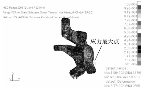
图 5 紧急制动和穿过不平路面同时发生时应力分布云图(单位:MPa)
